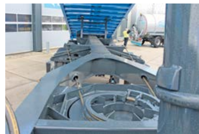
Wywrotka ma charakterystyczną centralną ramę, dzięki której ma charakteryzować się 10-krotnie większą sztywnością niż tradycyjne konstrukcje
