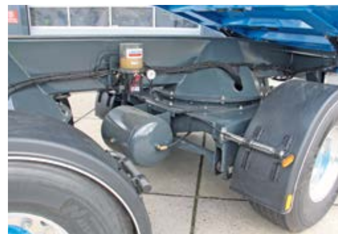
Układ skrętnych kół nie jest nową technologią. W firmie D-Tec funkcjonuje z powodzeniem od 30 lat w cysternach
