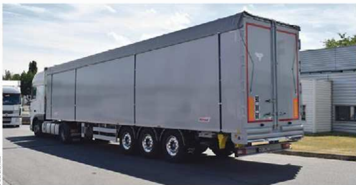
[ Coła naczepa Benalu wykonana jest z aluminium, dzięki czemu jest bardzo lekka (maso własna JUMBOLINER od 6.900 kg) ]
